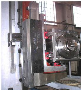
Neuer Spindelstock SKODA-Bohrwerk
