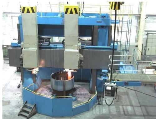
**Doppelständer-Karusselldrehmaschine CKD SK 40 CNC – 840 D**
