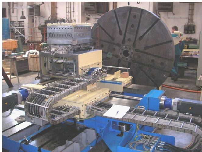
**Schwerdrehmaschine SKODA SUT 160 CNC – 840 D**
