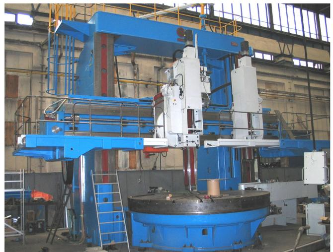
**Doppelständer-Karusselldrehmaschine CKD SK 40 CNC – 840 D**
