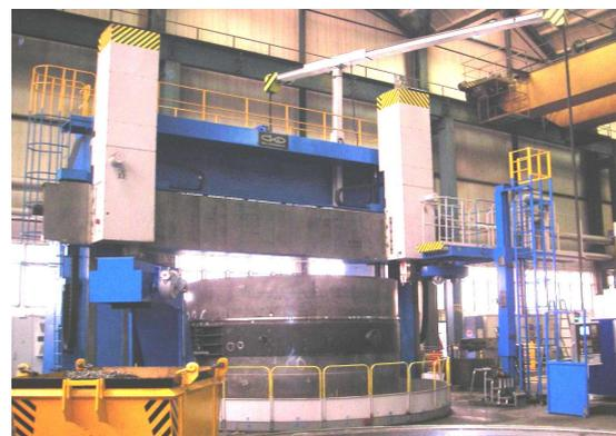
**Doppelständer-Karusselldrehmaschine CKD SK 25 CNC – 840 D**
