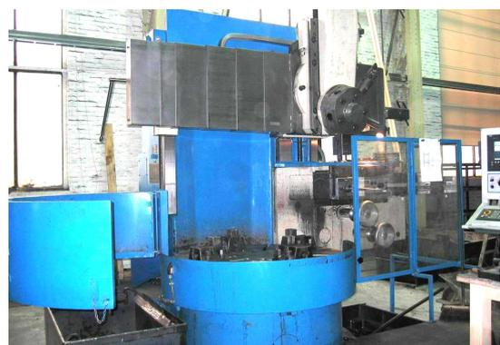
**Plandrehmaschine ZERBST DP 2 CNC – 840 D**
