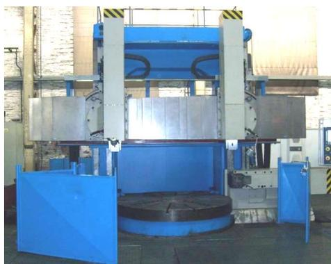
**Einständer-Karusselldrehmaschine SEDIN 1516 CNC – 810 D**
